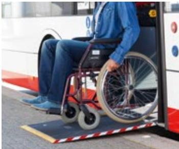
Busrampen können vom Fahrer nur an Haltestellen mit erhöhtem Bordstein ausgeklappt werden.
